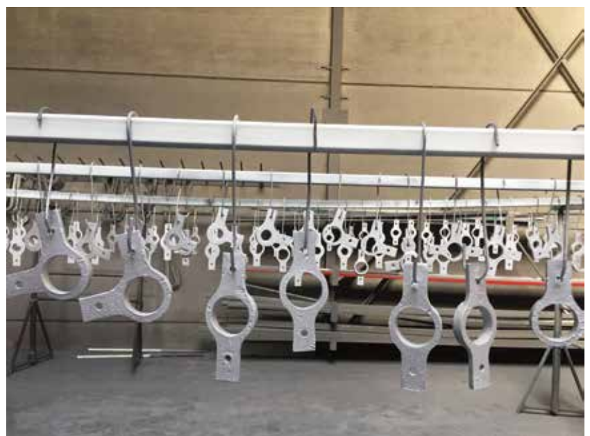
De in zandvorm gegoten koppelstukken na metallisatie (foto A. Gorlé)
